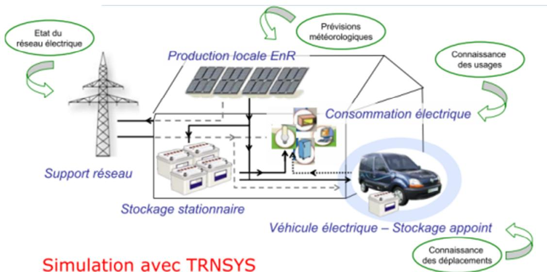
Figure 23 - Modèle de smart home avec Vehicle to Grid (source: CSTB)
