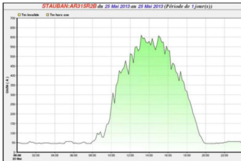
Figure 33 - Production PV en entrée du poste source St Auban le 25/05/13 – En intensité (source : ERDF)
