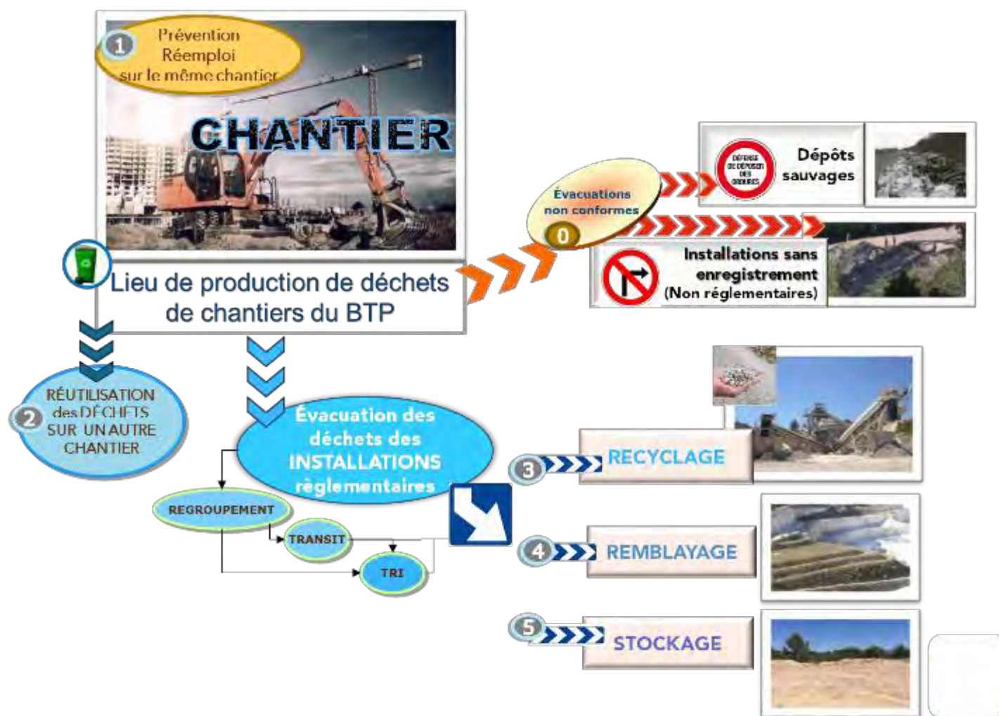
Figure 32 : Schéma général des flux de déchets inertes du BTP issus de chantiers et leurs filières de traitement
